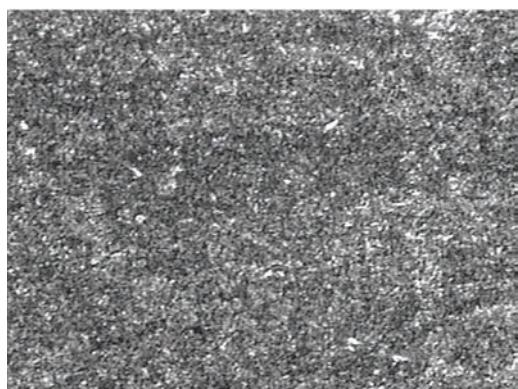
Микроструктура закаленного слоя тростит отпуска и равномерно распределенные карбиды
